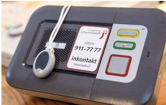
So kann ein stationäres Hausnotrufgerät aussehen, das ans Festnetz angeschlossen wird. [Foto: Johanneswerk]
