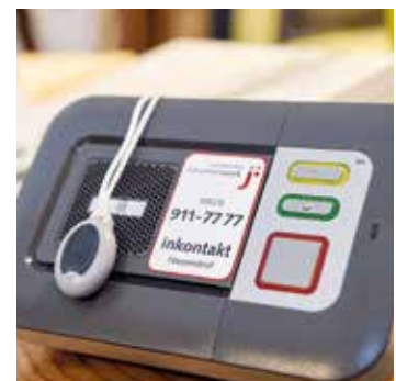
Das Hausnotruf-Gerät lässt sich aufgrund seiner geringen Größe gut neben dem Telefon unterbringen. [Foto: Christian Weische]
